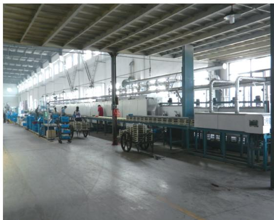
41米全自动隧道炉
